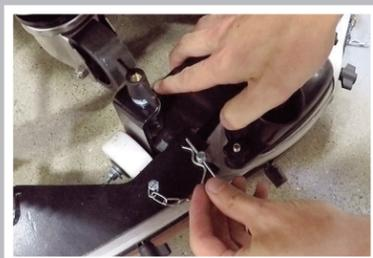
Instale el escurridor alineándolo en la parte posterior de la máquina y colocando los pasadores de retención.
