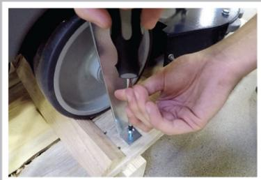
Use un destornillador Phillips para aflojar y quitar los soportes metálicos.
