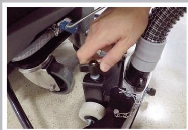
Ajuste el escurridor en la altura deseada usando las tuercas de la rueda guía.
