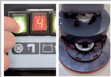
Presione el botón para activar la alimentación en la máquina. Centre el accionador de la almohadilla debajo de la plataforma de la fregadora para engranar con la máquina. Baje la plataforma de la fregadora en el accionador de la almohadilla.
