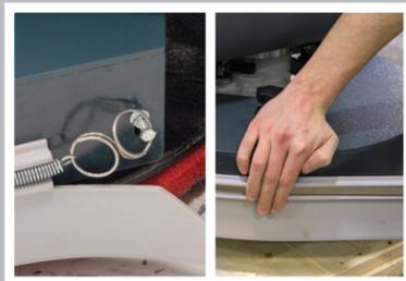
Para instalar el faldón de salpicadura, enganche los anillos de metal con la tuerca del conector y coloque el faldón alrededor de la plataforma de la fregadora. Baje la plataforma de la fregadora al piso con su almohadilla o cepillo instalado y deslice el faldón hacia abajo hasta que toque el piso.
