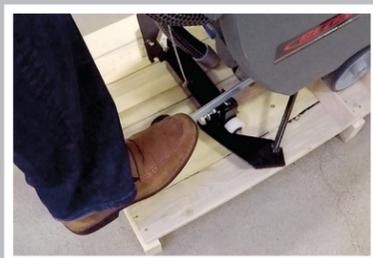
Levante la plataforma de la fregadora con el pedal en la parte trasera derecha de la máquina.
