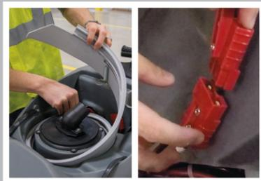
Busque y retire la protección contra salpicaduras de la carcasa del tanque de recuperación. Busque y conecte los cables de la batería.
