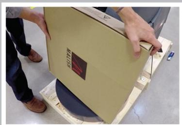
Retire la caja que contiene el cargador de la batería y la caja que contiene el conjunto del accionador de la almohadilla.
