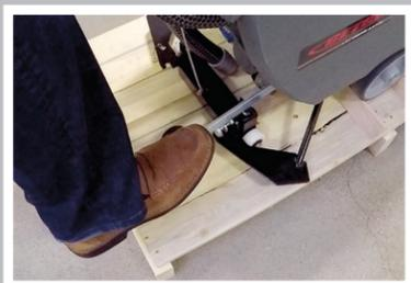
Presione y bloquee el pedal en la parte posterior derecha de la máquina para levantar la plataforma de la fregadora.
