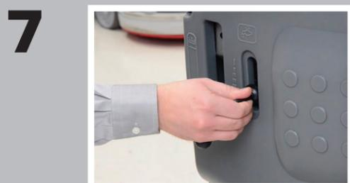
**7** Use la palanca de control de la solución para encender o apagar el flujo de la solución. Posicione la palanca en el caudal deseado.
