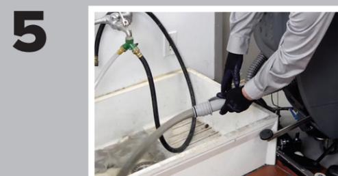
**5** Vacíe el tanque de recuperación después de cada uso. Retire la manguera del gancho de la carcasa en la parte posterior de la máquina, retire la tapa y deje que el agua sucia se vacíe en el fregadero.
