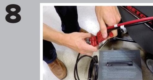
**8** Conecte la batería al cargador.
