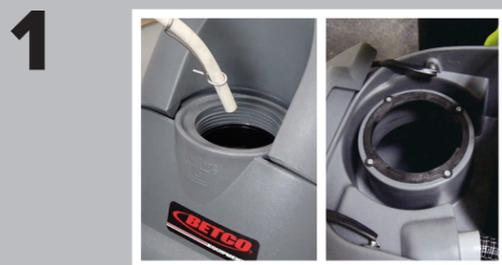
**1** Llene la máquina con agua y detergente. Asegúrese siempre de que el tanque de recuperación esté vacío antes de cada uso.
