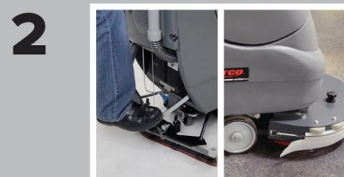
**2** Presione el pedal para levantar la plataforma de la fregadora.
