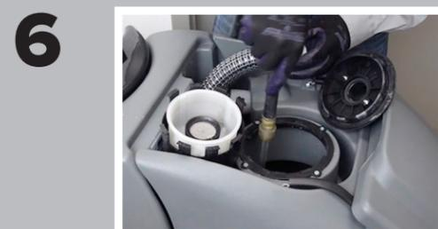
**6** Con la manguera de drenaje aún en el fregadero, enjuague el tanque de recuperación con agua. Cuando esté limpio y vacío, coloque el tapón y el gancho nuevamente en la carcasa.
