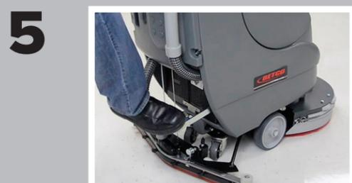
**5** Suelte el pedal y coloque la plataforma de la fregadora sobre el accionador de la almohadilla.
