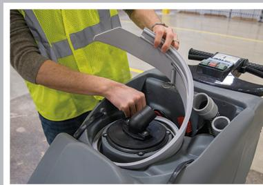
Faldón de cepillo y abrazadera de sujeción, ubicados debajo de la tapa del tanque de recuperación
